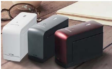
La práctica impresora de RICOH puede extraer datos de las APLICACIONES en el teléfono y la computadora del usuario vía Bluetooth y USB, y puede imprimir fácilmente textos, imágenes, códigos de barras y códigos QR en diferentes materiales con un solo toque. Con solo 315 g, los usuarios pueden imprimir en cualquier lugar y en cualquier momento.
