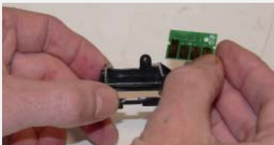
11 Instale un nuevo chip y reemplace el tornillo.
