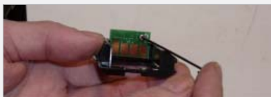
10 Con la llave Allen de 1.27 mm retire el tornillo y el chip.
