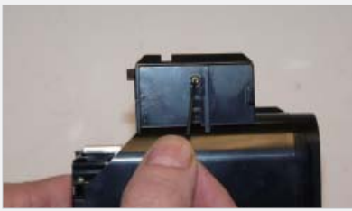
12 Instale el soporte del chip y el tornillo.
