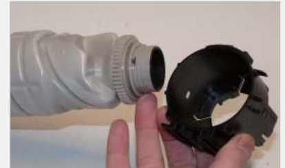
3 Levante las tres pestañas pequeñas en la cubierta del puerto exterior y retire la cubierta.
