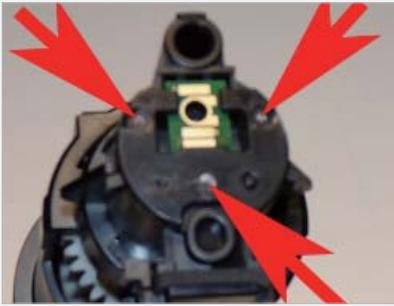
**Paso > 11** Coloque tres gotas de silicona negra o pegamento caliente para sostener el chip en su sitio.
