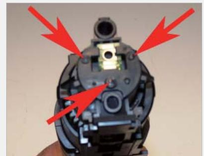
**Paso > 8** Corte los tres remaches plásticos de la cubierta del chip.
