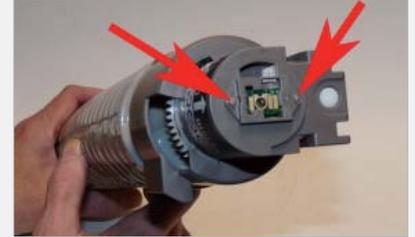
**Paso > 18** Corte los dos remaches de plásticos de la cubierta del chip.
