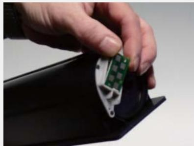
**Paso > 30** Levante e instale el chip nuevo.
