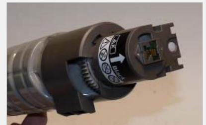
**Paso > 20** Instale un nuevo chip y reemplace la cubierta.
