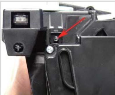
**Paso > 14** Presione el alojamiento del chip en su lugar. Asegúrese que las tres pestañas estén bloqueadas y que la cubierta se ajuste correctamente alrededor de la pestaña de alineación.
