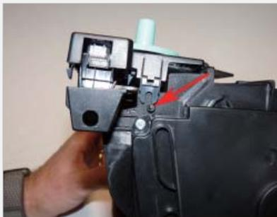
**Paso >** **9** Presione las tres pestañas para aflojar la cubierta. Tenga cuidado de no romper la pestaña de alineación.
