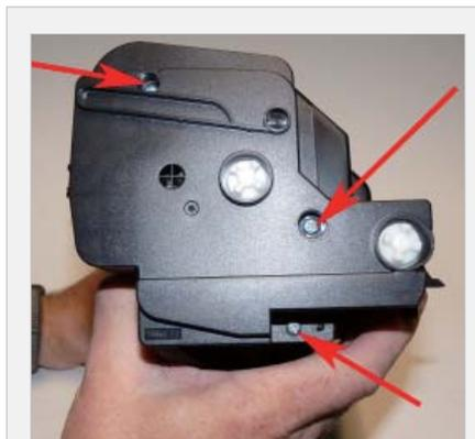
**Paso >** 2 En el lado derecho del cartucho o del lado del engranaje, remueva los tres tornillos y la tapa lateral.
