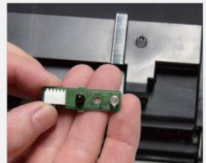
**Paso >** **12** En el extremo opuesto de los cables hay una placa de sensor de tóner. Se muestra aquí sólo con fines informativos.
