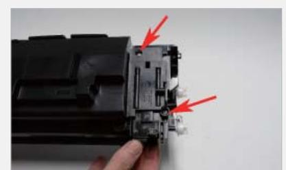
**Paso >** 5 Remueva los dos tornillos del conjunto de la cubierta del puerto con resorte.
