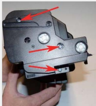
**Paso > 17** Vuelva a colocar la tapa lateral del lado del engranaje y los tres tornillos.
