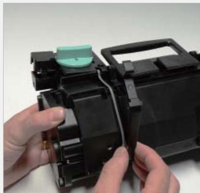
**Paso >** **10** Levante la cubierta del cable y retírela.
