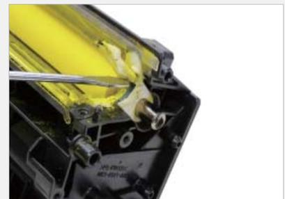
**Paso > 30** En el lado derecho de la cámara levante el sello del rodillo revelador sello del fietro. Levante desde la parte delantera y pone en la parte trasera.
