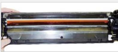
**Paso > 14** El conjunto de la película ámbar se mantiene con la cinta adhesiva de doble cara. Si esto no está siendo pegado o una nueva cuchilla limpiadora no está siendo utilizada, reemplace la cinta. Reemplace la película.
