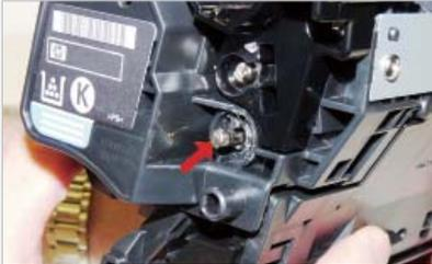
**Paso >** **3** Remueva los fines con el cortador de cables. El pin menor se encaja en el lado de contacto del cartucho, el pin largo en el lado de la etiqueta o del engranaje.
