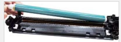
**Paso > 17** Instale el tambor. ELhub lado corto sobre la planta del tambor largo/pin del eje. Asegure de que no hay grasa conductiva en la planta del tambor / Pin del eje.
