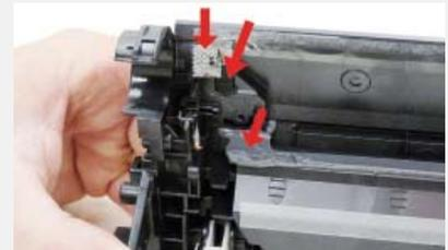
**Paso >** **12** Limpie los sellos del fieltro en ambos fines de la cuchilla limpiadora. Si la cola de la WB tiene tóner en ella, limpie con alcohol y esponja. Si no llega a ficar pegajosa de nuevo, tiene que ser removida y una buena junta de silicona será utilizada para sellar la cuchilla. GE 100% Silicone y Phenoseal son dos buenas marcas para esto.
