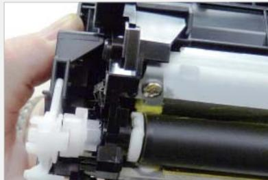
**46** Coloque el triple engranaje en el eje de rodillo revelador y encaje en el conjunto del resorte sobre la tapa. Instale la tapa e los dos tornillos.
