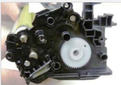
**Paso > 23** Remueva todos los engranajes como mostrados, excepto el engranaje de la mezcla de la paleta y el engranaje sellado. El engranaje de mezcla se une a la paleta dentro de la tolva y es muy difícil volver a reunir correctamente.
