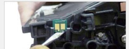
**51** Si el nuevo chip de reemplazo está suelto en la ranura, cierre los bordes superiores con pequeñas cantidades de pegamento caliente.
