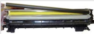
**42** Instale el rodillo revelador limpiado. (NO utilizar los productos químicos para limpiar. Un paño sin pelusa funciona bien. Coloque el final controlado ara el lado del engranaje y la grasa conductiva en el lado de contacto.
