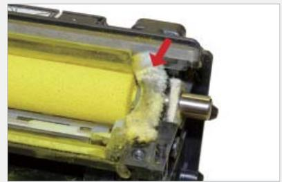
**39** Presione el sello del fieltro del rodillo revelador en su lugar. Asegure de que se encaja en la hoja de retencion. Si el pegamento no está pegajoso, coloque una pequeña bola de 100% de silicona adhesiva para bloquear en su lugar. ¡No logre la silicona en la parte superior del fieltro! Este fieltro tiene una tendencia a curvarse cuando se re-instala. La imagen no se muestra de la manera correcta. Asegure de que el fieltro es recto o se fuga.
