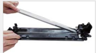
**Paso >** **10** Remueva los dos tornillos de la cuchilla limpiadora. Deslice la navaja de afeitar a lo largo de la parte trasera de la cuchilla para liberar de la cola. Remueva la cuchilla limpiadora.
