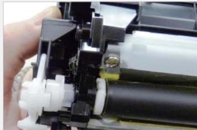
**47** Coloque las dos mitades juntas de contacto primero. Sobre el engranaje, presione la palanca en el lugar. En el lado de contacto, rompa la cerradura para la tapa.
