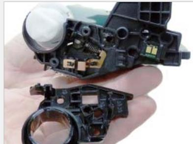
**Paso >** **6** En la cámara de residuos, remueva los dos tornillos de la tapa del engranaje del tambor. Pulse en la pestaña como se muestra y remueva la tapa. No hay necesidad de remover la tapa del lado opuesto.
