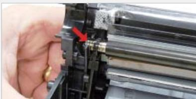
**Paso > 16** Coloque la grasa conductiva en la parte trasera del soporte negro del eje.
