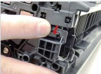
**Paso >** **4** En el lado del engranaje, presione en el mecanismo de bloqueo del plástico.
