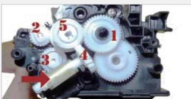
**44** Instale los engranajes en el orden indicado. Si instala un sello, deslice el final del sello a través del take-up engranaje y rodee la cola apretado en el rodillo.
