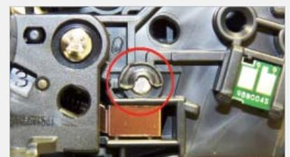
**Paso > 20** En la cámara de suministros, remueva los dos tornillos de la tapa del engranaje.
