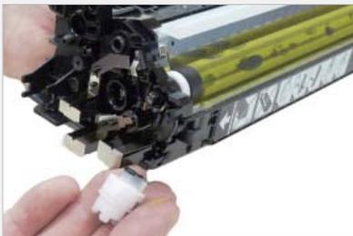
**Paso > 25** Remueva el engranaje de motor del triple rodillo revelador (S).
