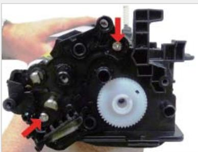
**Paso > 26** En el lado del engranaje de la tapa interior, remueva los dos tornillos y la tapa.
