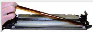
**Paso >** **9** Para remover la cuchilla limpiadora, el conjunto de la película ámbar debería ser removido. Deslice una navaja de afeitar debajo de la barra de montaje de plástico, y remueva el conjunto.
