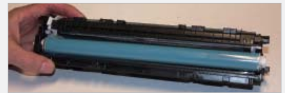
29 Cubra el cilindro con su lubricante preferido e instale el cilindro en la cavidad de desperdicio.
