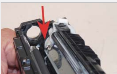
28 Coloque ambas mitades juntas. Levante la lengüeta negra mientras jala la cubierta lateral para alinearlas adecuadamente.
