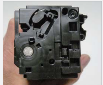
30 Coloque una pieza de cinta con doble adhesiva en el interior de la cubierta lateral. Limpie y reemplace la grasa conductiva en el eje del cilindro e instale la cubierta lateral.
