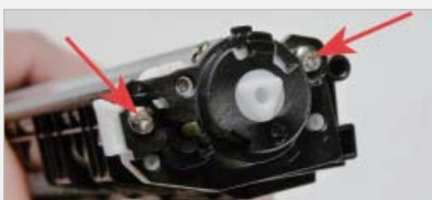
26 Instale la cubierta lateral y ambos tornillos.
