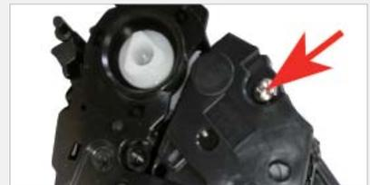
7 قم بتنظيف كل بقايا الحبر من الغطاء. كن حذرًا من إتلاف شفرة التصليح الموجودة بجانب الماسحة، إذا انتفت تلك الشفرة فإن الخرطوشة سوف تتسرب. تأكد من أن أقفال الماسحة نظيفة
