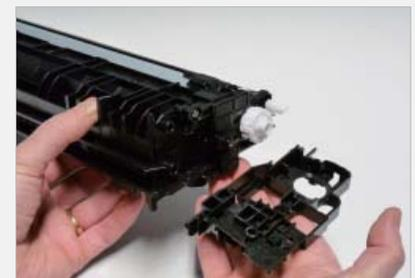
**1** Con la etiqueta enfrentada hacia ti, en el lado izquierdo del cartucho, retira el tornillo y la tapa lateral.
