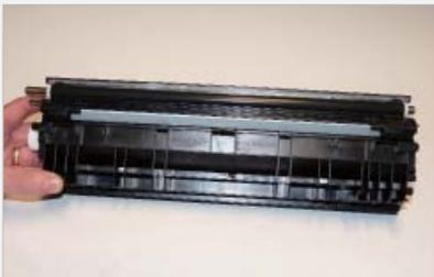
**Paso > 15** Limpia e instala la cuchilla dosificadora, los 2 tornillos y la tapa. Ver figuras 19 y 20. ¡Recuerda el lado derecho usa el tornillo de rosca izquierda!
