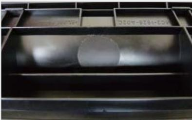
**Paso > 14** Cubre el orificio de llenado con una etiqueta que tenga un adhesivo agresivo para que no haya fugas después.
