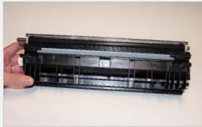
**Paso > 16** Instala el rodillo revelador y 2 bujes blancos. El lado del eje más largo, al lado izquierdo del cartucho.
