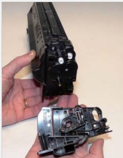
**Paso >** **8** En el lado derecho, retira la placa de identificación, el tornillo y la tapa lateral exterior.
