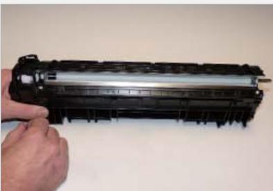
**Paso >** **6** Levanta con cuidado la cubierta del Doctor Blade. (está sujeta con cinta adhesiva de doble faz).
