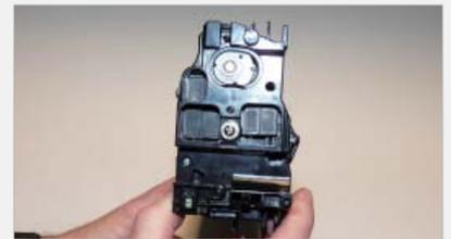
**Paso > 22** Instala la tapa lateral exterior y el tornillo.
