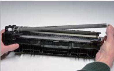
**Paso >** **5** Retira el rodillo revelador deslizándolo hacia afuera. Asegúrate que ambos bujes blancos vengan con ellos y que se coloquen a un lado en un lugar seguro.
