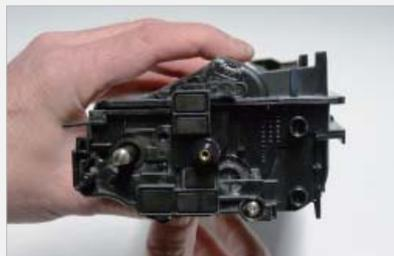
**Paso > 18** Instale la tapa lateral interna del lado derecho y el tornillo.
