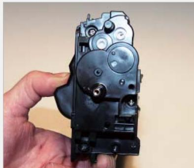
**Paso > 17** Instala la tapa lateral interna de la caja de engranajes del lado izquierdo y dos tornillos.
