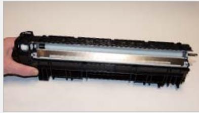
**Paso >** **7** Retira los dos tornillos y la Doctor Blade. El tornillo del lado derecho es un tornillo de rosca izquierda. ¡Asegúrate de colocarlo en un lado donde no se mezcle con los otros tornillos!
