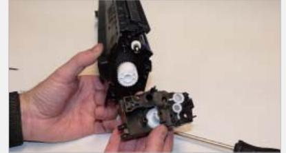
**Paso >** **9** Retira los dos tornillos de la tapa lateral interior, retira la tapa lateral.
