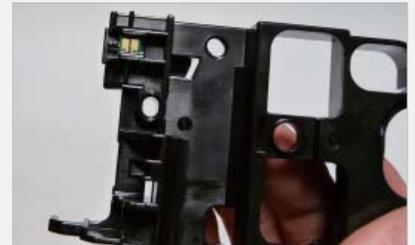
**Paso > 21** Reemplaza el chip en la tapa lateral exterior.
