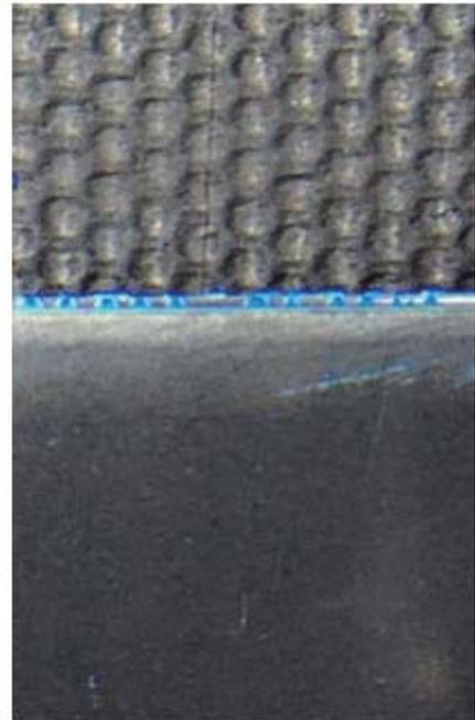
Usando un iPhone con lupa de impresora para resaltar las marcas en el rodillo revelador debido a la acumulación de tóner en la cuchilla dosificadora. ¿Cuál fue la verdadera causa?
